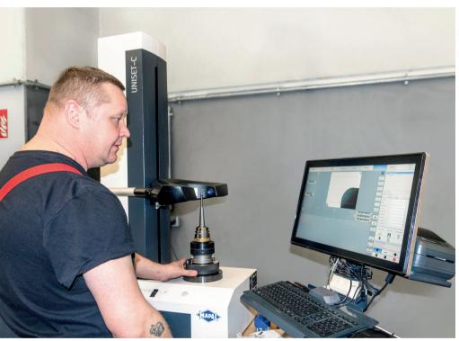
**Richtig verbunden:** Am Werkzeugeinstellgerät Uniset-C bereitet David Frommhold das Werkzeugsystem vor. Das Messprogramm erhält er direkt aus dem CAM. Das Messprotokoll wird über die c-Connect Box an die Maschine übergeben. © Mapal
